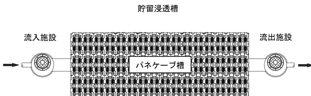
図-1 雨水貯留浸透施設の基本構成
