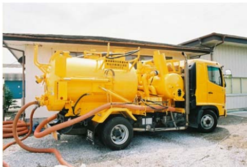
写真－４ 吸引作業車 ※吸引風力 40 m³/min
